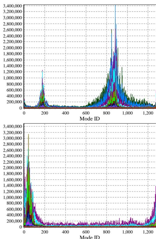
図 8: 測定されたソレノイド磁石のオン (上図)、オフ (下図) による不安定モードの変化 [14]
