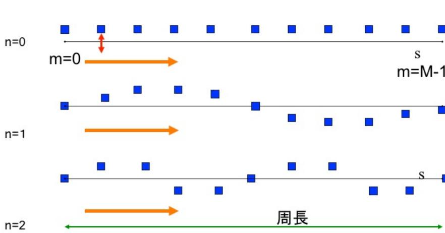
図 2: 多バンチの振動のモード
